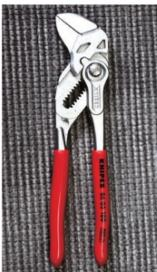
左: 国内のオンタイムエンデューロ同様に、進行は電波時計でおこなわれるので、腕時計なども電波時計にしておくが便利。本誌宮崎は気圧センサーやコンパス内蔵、ソーラータイプのCASIOプロトレックを愛用 中: 身につける荷物を減らすならGiant Loopなどのバッグが便利。FOXのホーテジ ハイドレーションパックは飲料3L、バッグ容量20.5Lで便利 右: クニベックスのプライヤーレンチ (8603-180) は全長180m、35mmナットまで対応するのでアクスルレンチ代わりにする。持っておいて損はない
