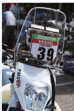
風圧低減や雨によるマップホルダー、メーターへのダメージを軽減するためのフロントバイザーは便利。転倒時の破片飛散防止、衝突時の保護やビビリ防止に、ゴム製の縁をつけている
