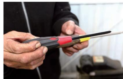
ちなみに比較用で用いたスーパークッションドライバーだが、ラバー製のグリップのクッションが心地よく、疲労時にも最適。VESSEL全体に共通する、肝心の触先の「噛み」も高く、思わぬ発見をした
