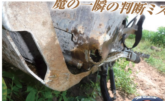
調子良く走っていた4日目のSS4。マップを見た瞬間に路肩の岩に気づかずエンジンを直撃。ジェネレーターカバーに穴を開け、オイルが吹き出てその場でストップ。ついに痛恨のデリタイヤを喫してしまいました。のどかな青空で待つこと3時間。思わずブルハの「青空」を口ずさんでました…
